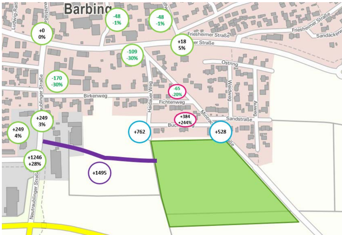
Abbildung 9 Veränderung der Verkehrsbelastung bei der Bypass-Lösung
