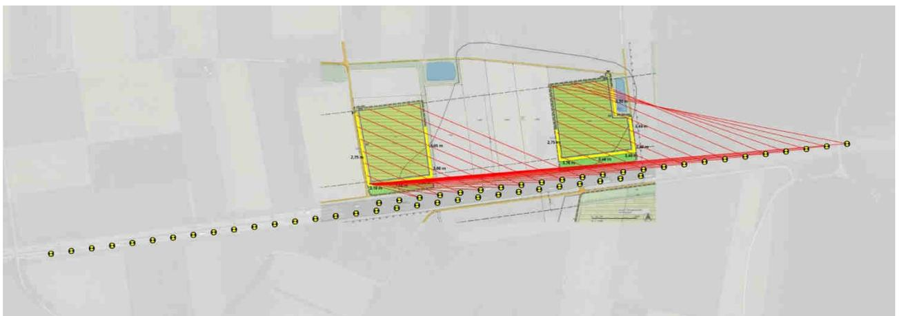
In beiden Fahrtrichtungen werden die für eine mögliche Blendwirkung an den Moduloberflächen relevanten Einblickwinkel durch den vorgesehenen Sichtschutz unterbrochen.
