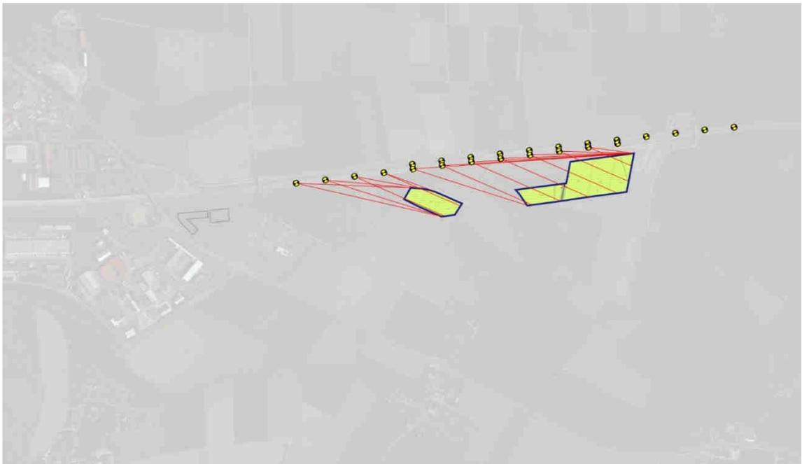
Bei der vorliegenden Geometrie wurden in Richtung der entfernten Beobachter Reflexionen bei tief stehender Sonne ermittelt und die beim Näherkommen verschwinden.
