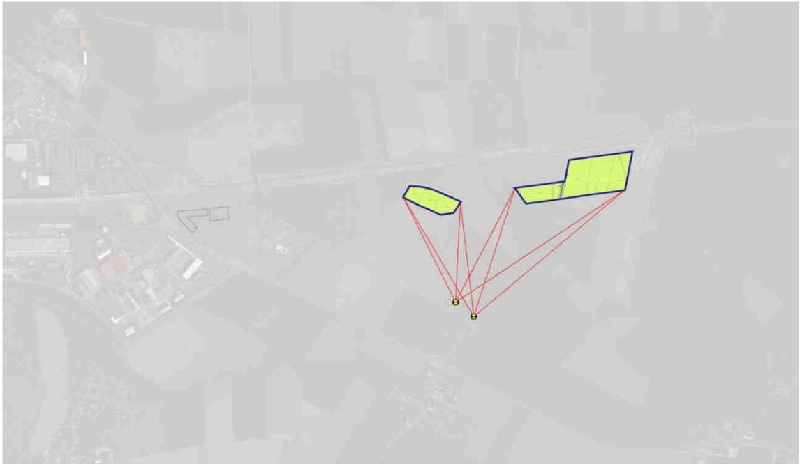
Für diese Winkelkonstellation wurden keine Sonnenstände ermittelt, die bei der gegebenen Situation und an diesem Standort Blendreflexionen in Richtung der relevanten Blickrichtungen auslösen können.
